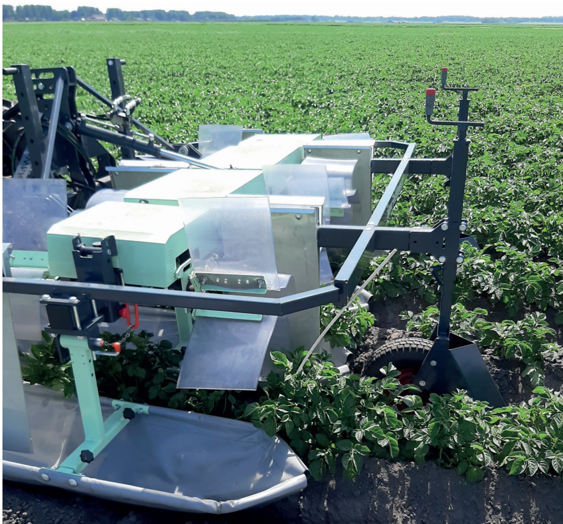
Mechanische bestrijding van coloradokevers door de Colorado Beetle Catcher (foto:WUR).
